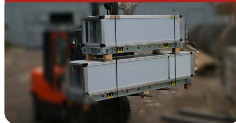
СПЕЦИАЛЬНЫЕ МЕТАЛЛИЧЕСКИЕ СТЯЖКИ НИЖНЕГО И ВЕРХНЕГО ЯРУСА
